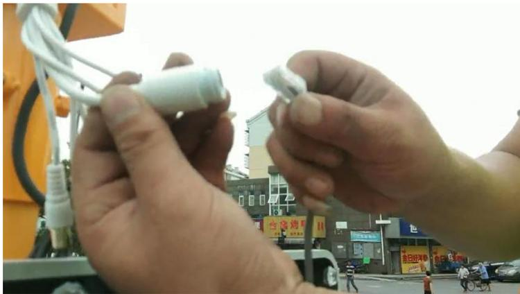
3.7 算法配置调整完成, 并测试确定智能人行道系统有效运行后, 拔掉智能斑马线相机宽带线, 将相机底座的背板用螺丝固定, 完成安装
